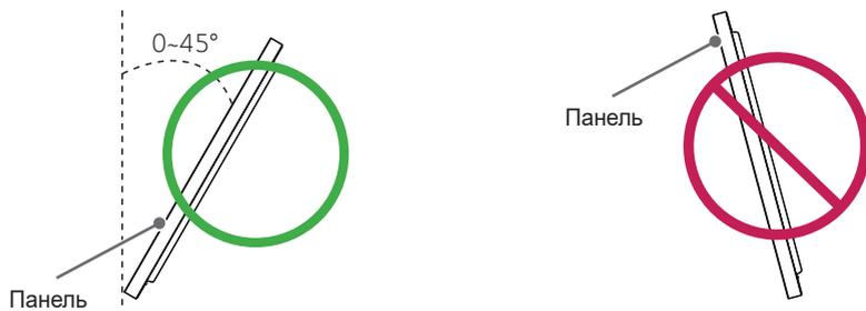
При установке монитора угол его наклона по вертикали может составлять до 45 градусов.
