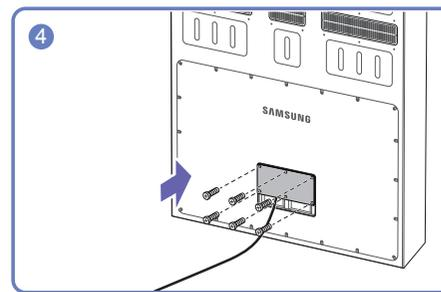
4 Закройте заднюю крышку и закрутите винты.
