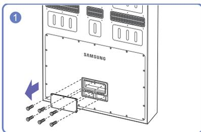
Выкрутите винты, затем снимите крышку.
