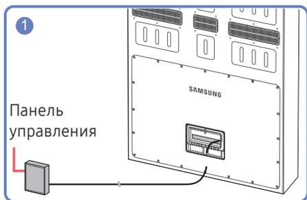
1 Подготовьте водонепроницаемый кабель питания, диаметр которого составляет 8.5 мм для 15 А.
