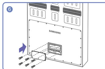
Закройте крышку, затем закрутите винты.
