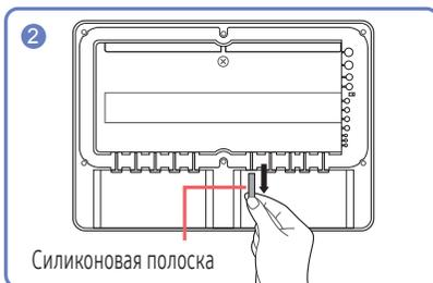
Снимите соответствующую силиконовую полосу, обеспечивающую толщину подключаемого кабеля.
