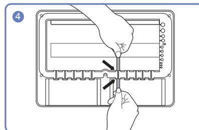
Вставьте нужный кабель в отверстие, из которого вы извлекли силиконовую полосу.
