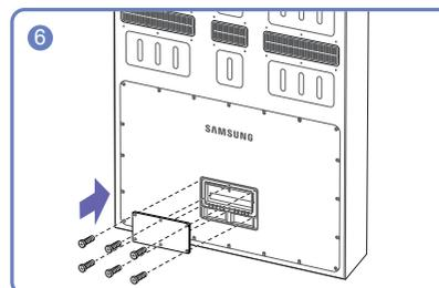
Закройте крышку, затем закрутите винты.
