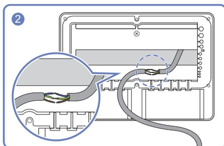
Подключите два кабеля питания друг к другу. Припаяйте и изолируйте подсоединенную часть.
