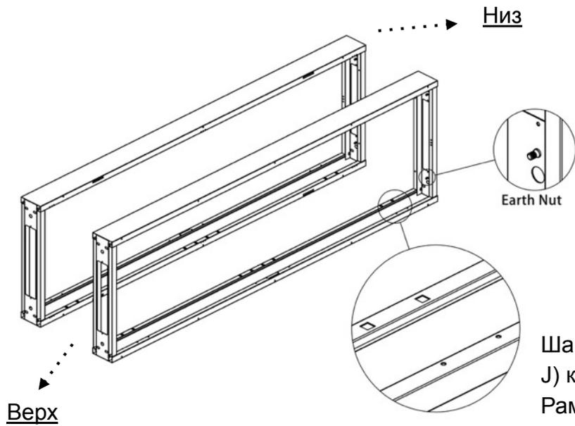
Шаг 2, Расположите рамы (Деталь S и J) квадратным отверстием внутрь. Рама с заземляющей гайкой является нижней
