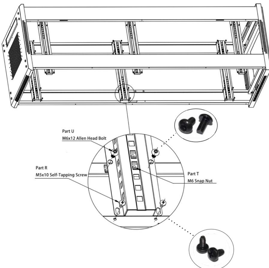
Шаг 5, Закрепите стопорные гайки M6 на соединительной планке (Часть G) и наденьте соединительную планку (Часть G) на раму (часть D). Просто избегайте отверстия для фиксации на раме (часть D). Используйте болт с шестигранной головкой M6x12 (часть U) и саморез M5x10 (Часть R) для крепления соединительной пластины (Часть G) к раме (часть D).
