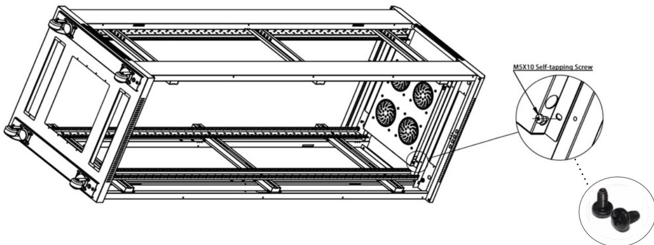
Шаг 8, Используйте самонарезающие винты М5х10 (Деталь R), чтобы установить поддон вентилятора (Деталь H) на рамы (Деталь D).
