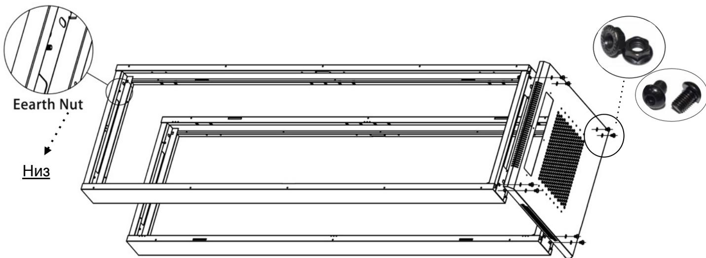
Шаг 3, Наденьте верхнюю крышку (Деталь E) с рамами (Деталь D), затем используйте болт с шестигранной головкой M8 \* 12 (Деталь Q) и гайки M8 (Деталь P), чтобы зафиксировать их вместе.
