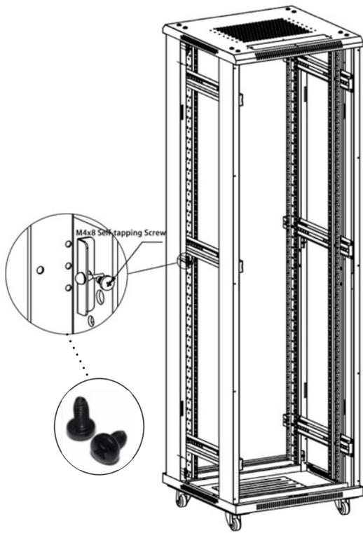
Шаг 10, Используйте самонарезающие винты M4x 8 (Деталь S) для крепления дверного стопора (Деталь М), 27U (8шт) 32U~47U (12шт)
