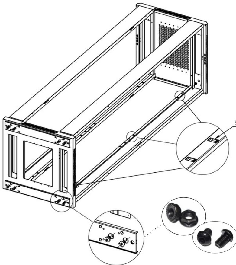
Шаг 4, Наденьте нижнюю крышку (Деталь F) с рамами (Деталь D), затем используйте болт с шестигранной головкой M8 \* 12 (Деталь Q) и гайки M8 (Деталь P), чтобы зафиксировать их вместе. Закрепите стопорную гайку M6 (Деталь T) на раме (квадратное отверстие)
