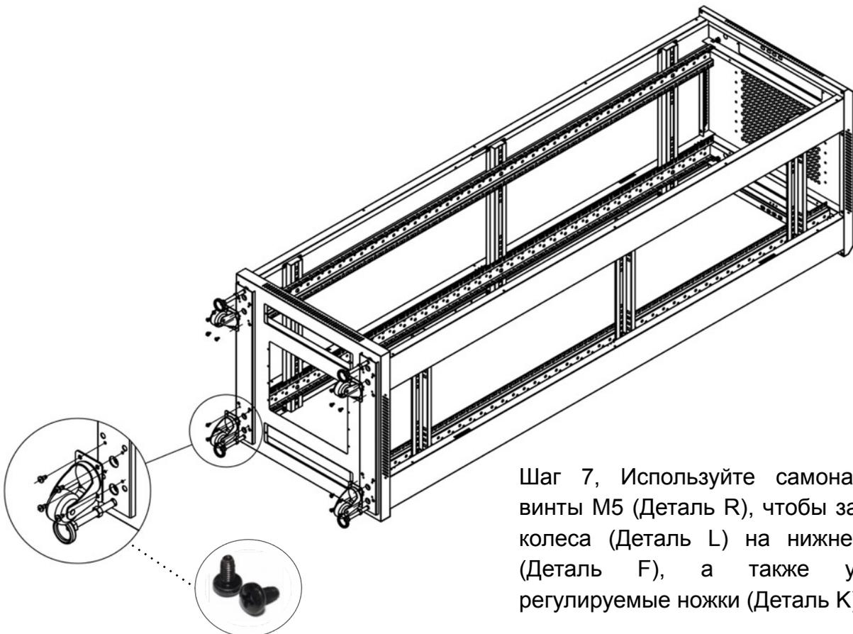
Шаг 7, Используйте самонарезающие винты М5 (Деталь R), чтобы закрепить 4 колеса (Деталь L) на нижней крышке (Деталь F), а также установить регулируемые ножки (Деталь K).
