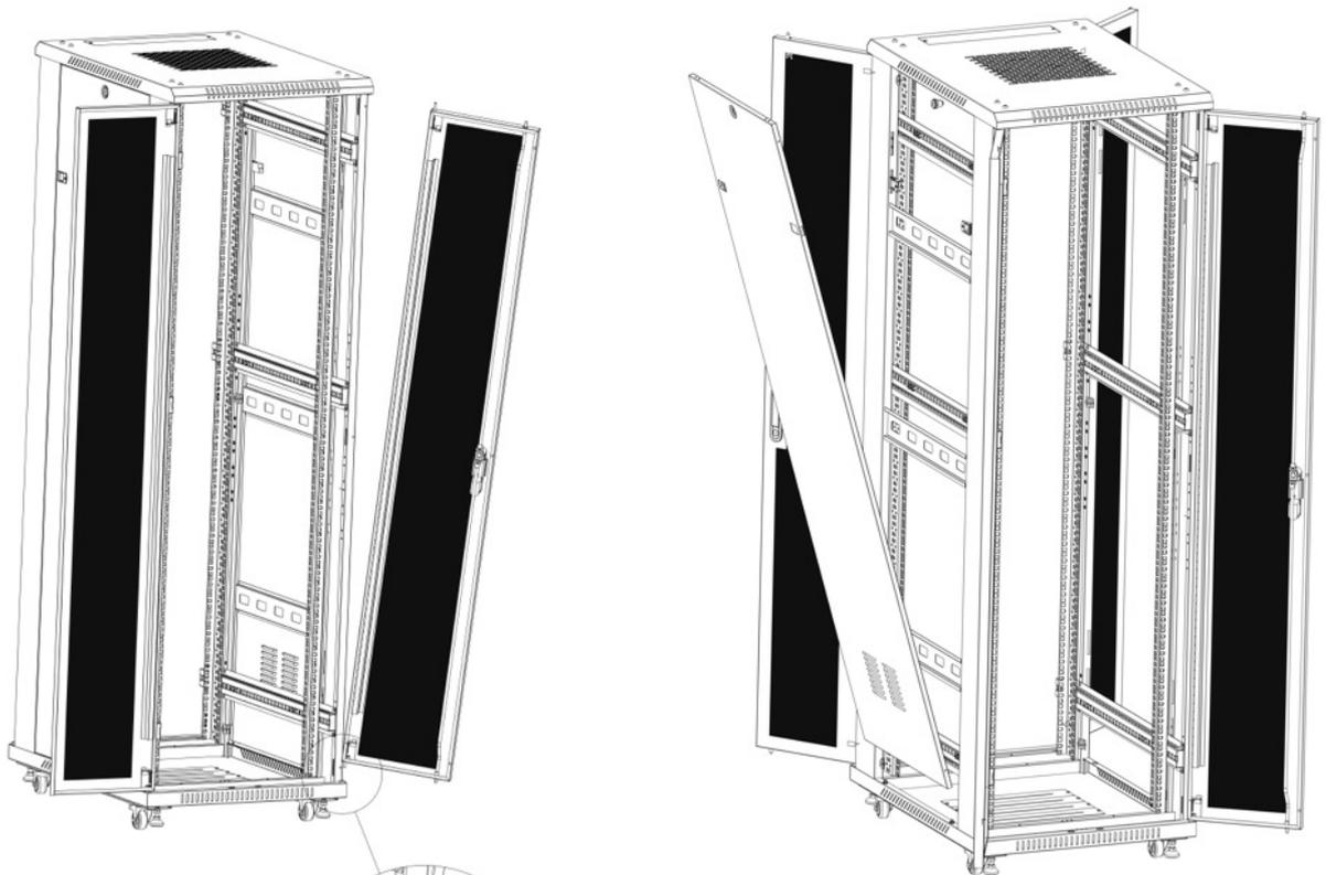
Шаг 11, Установите втулки (Деталь W) для установки передней двери (Деталь А), Установите втулки (Деталь W) для установки задней двери (Деталь В), Установите боковую дверь (Деталь С).
