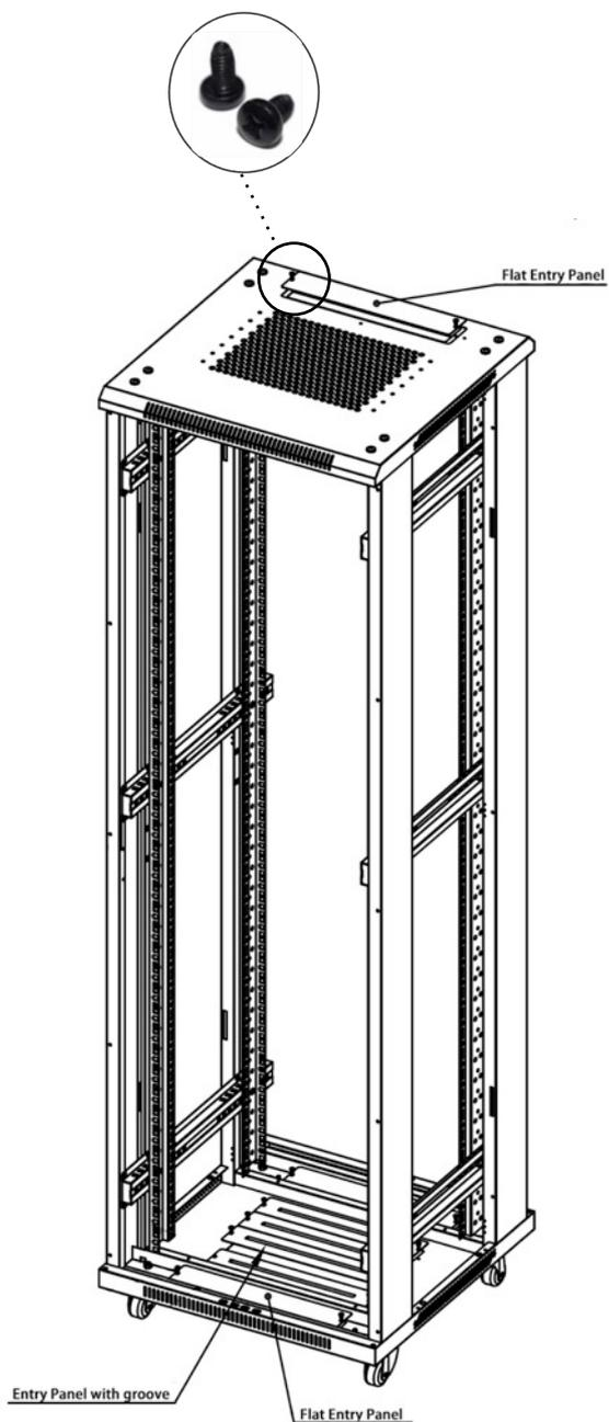
Шаг 9, Используйте Самонарезающие винты М4х 8 (Деталь S) для крепления панелей ввода (Деталь J).
