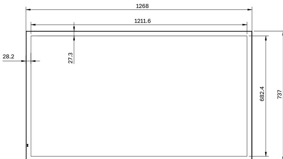
**СХЕМА ДИСПЛЕЯ (ВИД СЗАДИ)**
