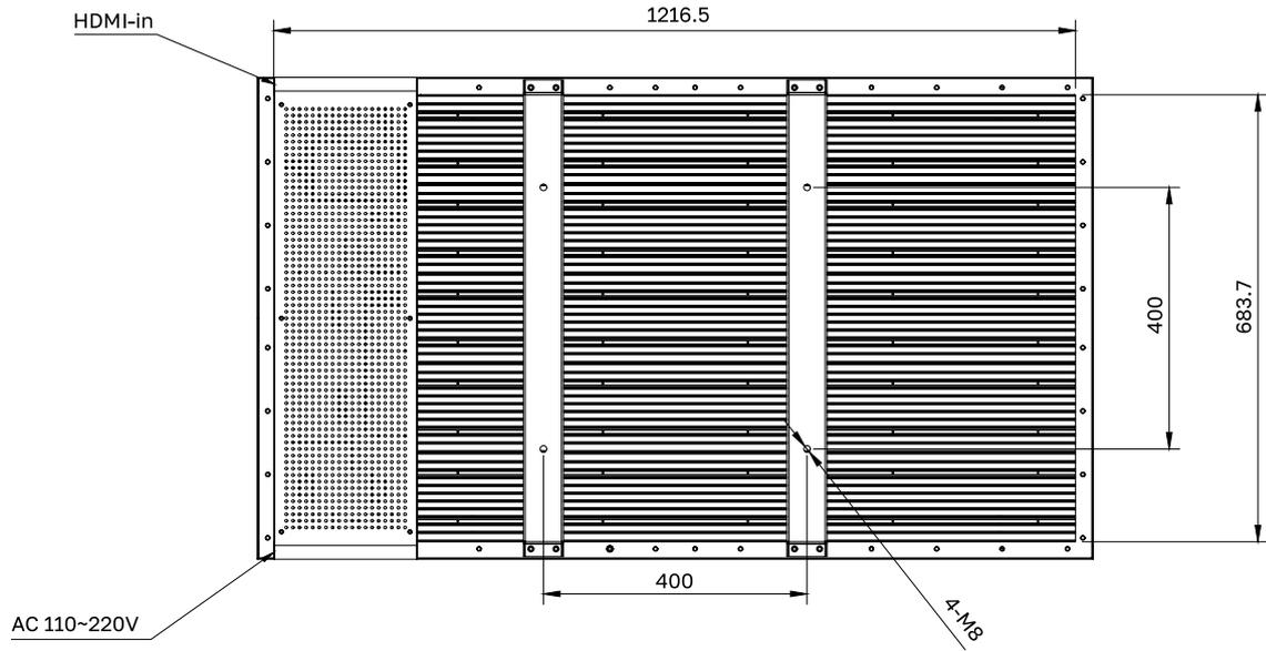
**СХЕМА ДИСПЛЕЯ (ВИД СНИЗУ)**
