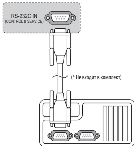
**Тип разъема: 9-контактный, вилка D-Sub**
