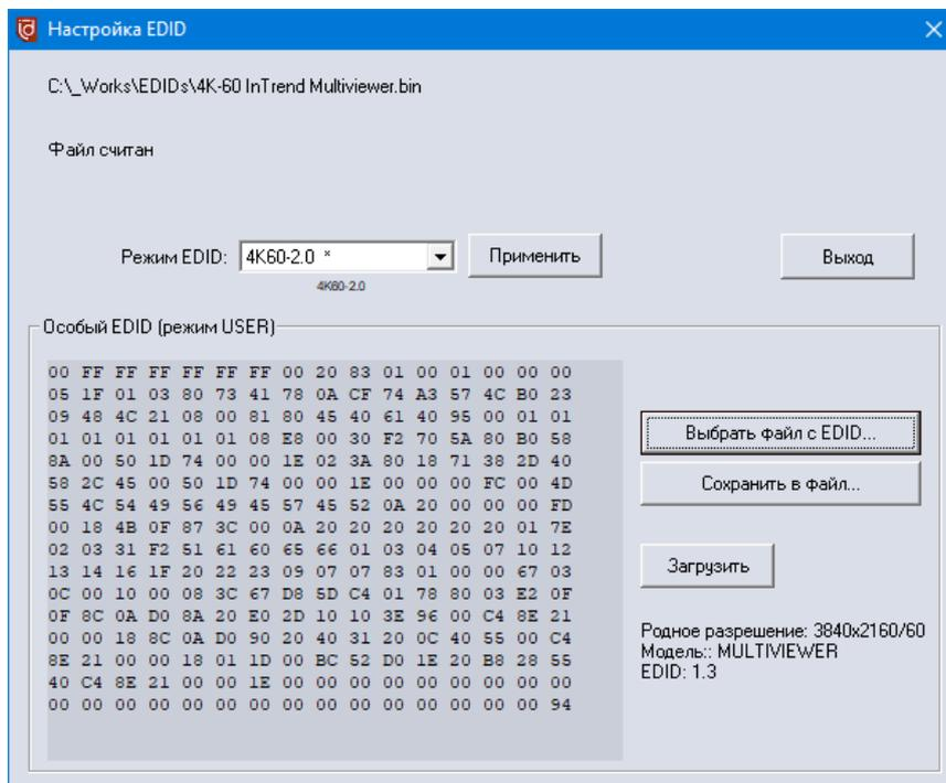
Возможные предустановленные (готовые) режимы EDID соответствуют перечисленным в [разделе «Установка режима EDID»](#), нужный режим можно выбрать в списке и далее нажать кнопку «Применить».
