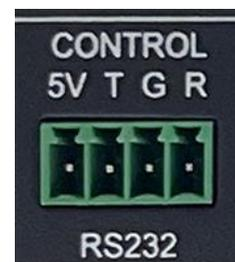
Контакт 5V для работы интерфейса RS-232 не используется. При необходимости данный контакт (совместно с контактом GND) можно использовать для подачи питающего напряжения +5 В на какое-либо внешнее устройство, требующее электропитания, при токе потребления до 100 мА.
