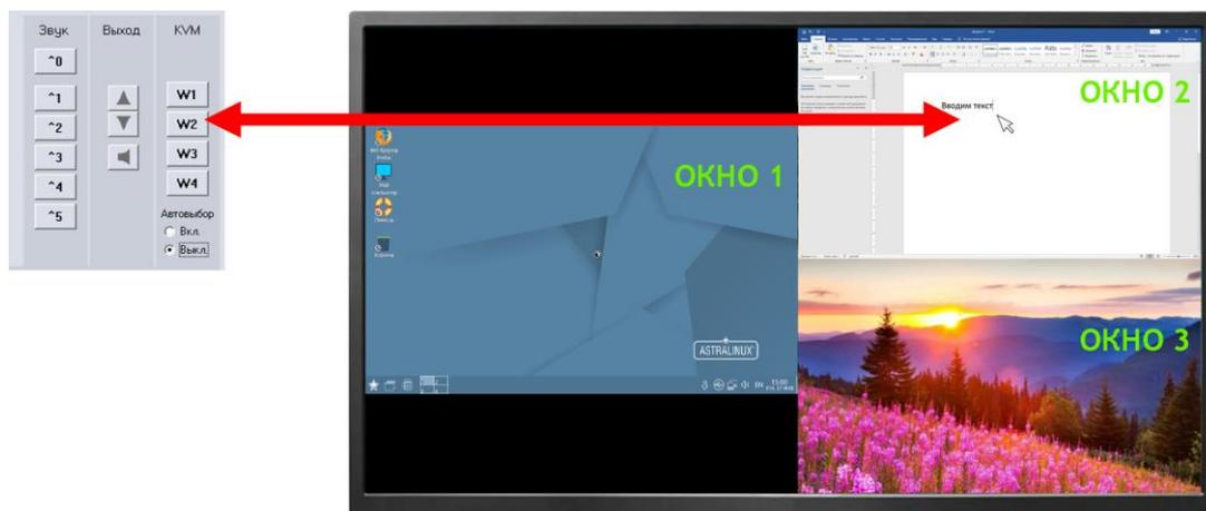
Например, если в окно 2 выведен источник HDMI3 (компьютер), то нажатие на W2 вызывает направление KVM на порт USB Host 3. Как результат, компьютер (изображение от которого выводится в окно 2) получает мышь и клавиатуру и работает с ними.
