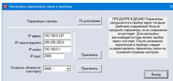
Если настройки изменились так, что связь с прибором прервалась (например, при связи через com-порт изменена скорость обмена по RS-232, либо при связи по TCP/IP изменён IP-адрес или иные IP-параметры), следует закрыть данное окно и в основном меню настроек соответственно скорректировать настройки связи с прибором.
