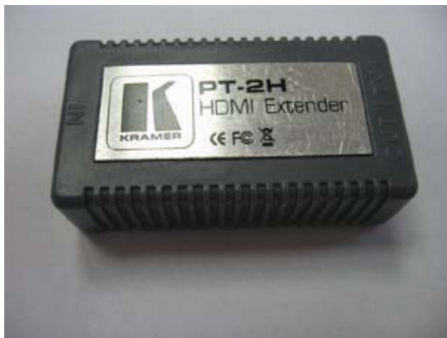
Рис. 1. Усилитель-эквалайзер HDMI PT-2H
