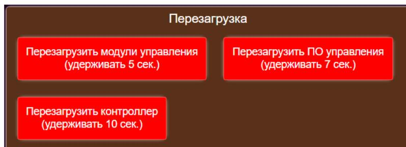
управления». Весь контроллер в целом перезагрузить (как при включении его питания) можно кнопкой «Перезагрузить контроллер».
