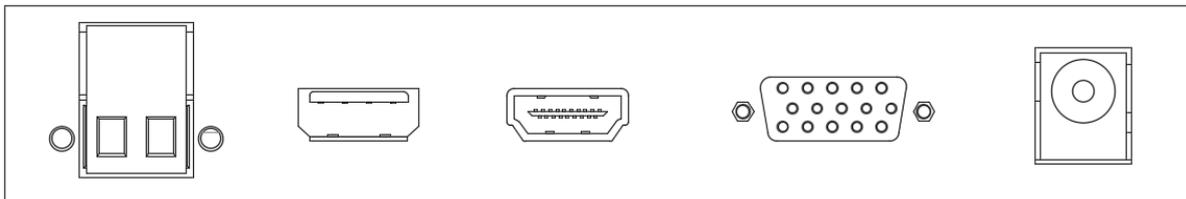
1.2.1 Двухконтактный клеммный блок PC\_SW – для удаленного включения ПК с помощью соответствующей кнопки в верхней части монитора.
