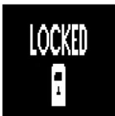
Воспользуйтесь функцией LOCK, чтобы не допустить случайных или неразрешенных изменений настроек аппаратуры. При попытке доступа к заблокированной функции на передней панели приемника появляется сообщение:
