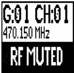
Используйте эту функцию для включения передатчика без воздействия на РЧ спектр.
