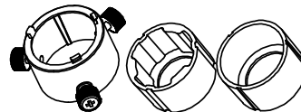
Adattatore microscopio (raccordi in gomma da 28mm e 34mm forniti in dotazione)
