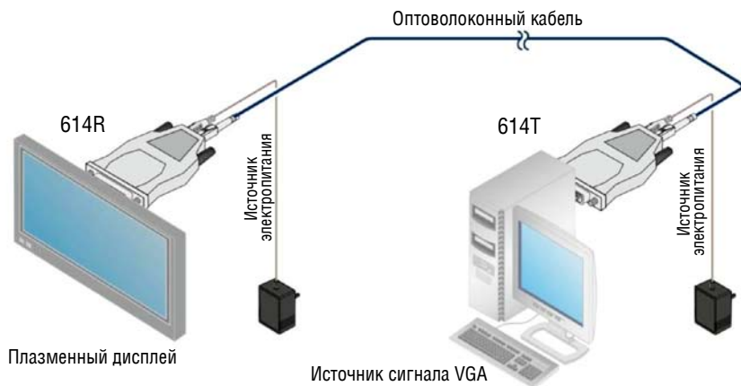
Рис. 2. Подсоединение системы 614T/614R
