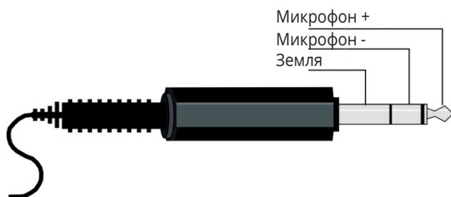
Рис. 4. Распайка кабеля для конденсаторного микрофона
