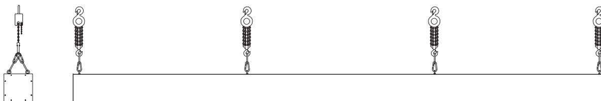
3. Используйте 4 лебедки требуемой длины, чтобы повесить экран на нужном расстоянии от потолка. Для большей сохранности цепей рекомендуется использовать специальные защитные кожухи. Подключите проекционный экран к сети для пуска.
