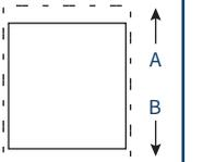
Ослабив данный винт крепления, можно регулировать положение экрана вверх-вниз в диапазоне 50мм. При достижении нужной высоты винт требуется закрепить.
