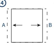
Ослабив винт крепления, можно двигать проектор в горизонтальной плоскости с шагом 50мм до подходящего положения.
