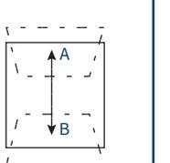
Регулирование винта вперед-назад позволяет достичь требуемый наклон проектора в диапазоне до 15°.
